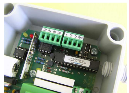
Schnittstellen USB-Buchse, USB-Klemmen und RS485-Klemmen (steckbar)
