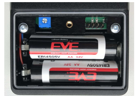
Batteriefach mit Trimmer u. Programmierschnittstelle
