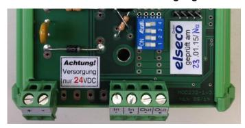
+/- 24 V DC In -/+ 0...10 V DC oder 0...20 mA oder Out -/+ 0...10 V DC oder 0...20 mA
